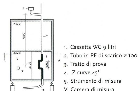
Prova eseguita presso l'EMPA, ente controllo per la Svizzera, lamina di Pb 0,5 mm.
